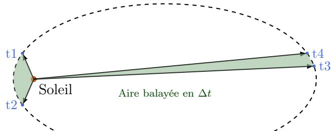
FIGURE 5 – Schéma illustrant la loi des aires
