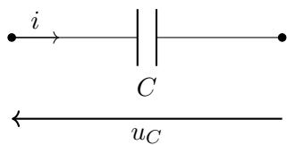
En convention récepteur, pour un condensateur idéal, l'intensité du courant électrique traversant le condensateur est proportionnelle à la dérivée de la tension à ses bornes par rapport au temps :
