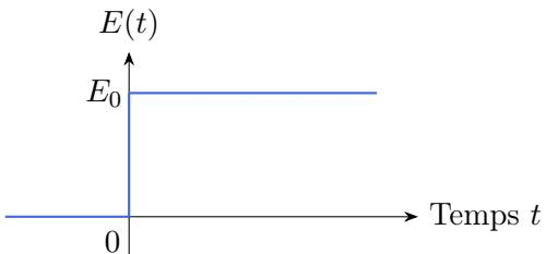
FIGURE 1 – Représentation d'un signal échelon
