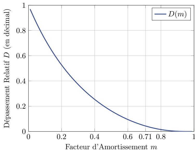
FIGURE 11 – Abaque Dépassement Relatif  $D$  vs. Facteur d'Amortissement  $m$
