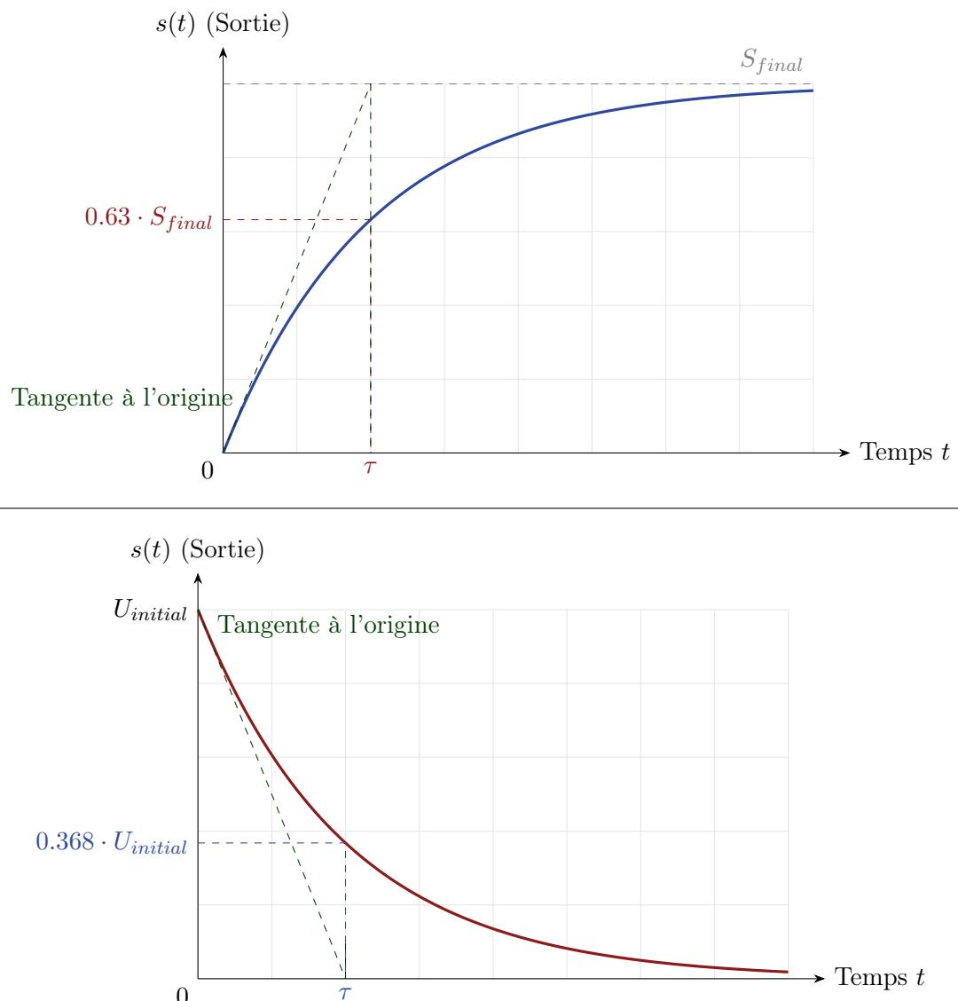
FIGURE 6 – Réponse indicielle d'un condensateur qui se charge et qui se décharge
