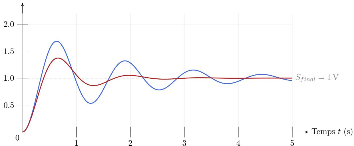
FIGURE 10 – Réponses indicielles de deux systèmes du second ordre sous-amortis ( $\omega_0 = 5 \text{ rad/s}$ )
