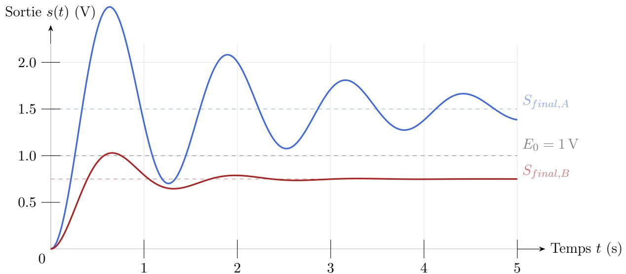
FIGURE 12 – Réponses indicielles de deux systèmes du second ordre sous-amortis.
