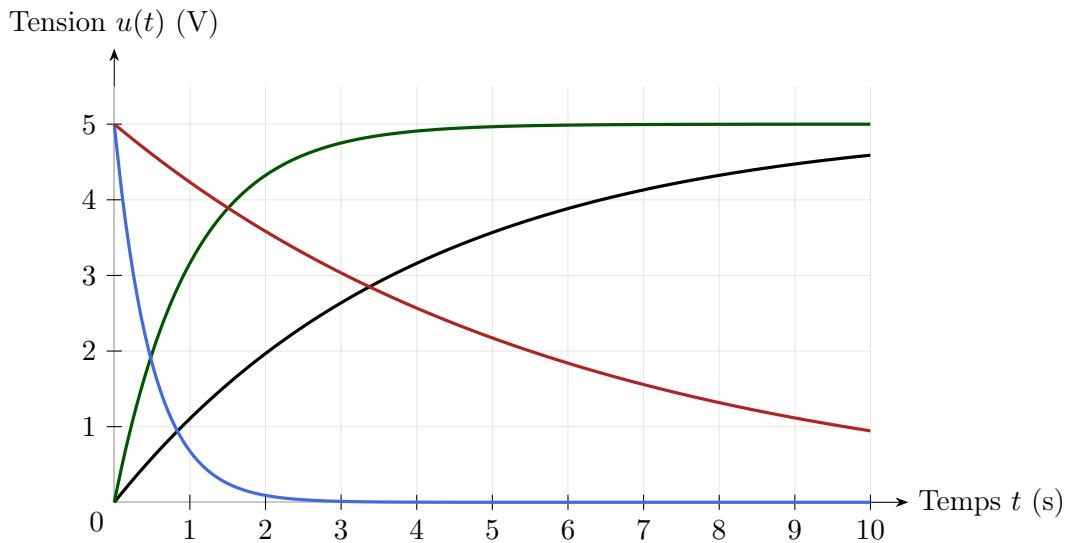
FIGURE 7 – Détermination de  $\tau$  pour différentes réponses de systèmes du premier ordre.
